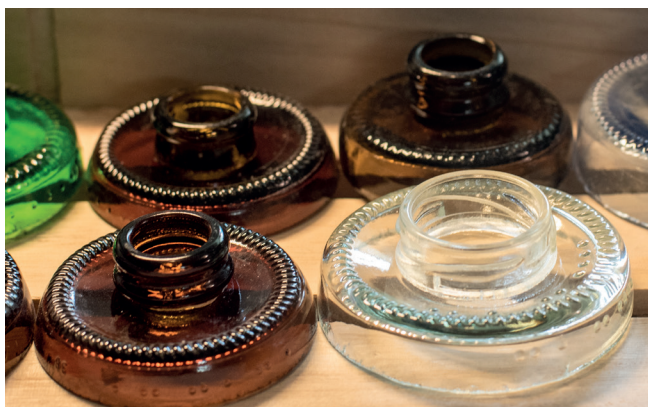
Lock till burkar eller fot till glas: toppen och botten av en och samma flaska har förberetts för sammansmältning i varmglasugn.
